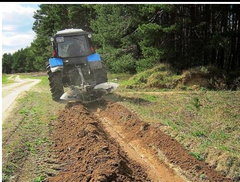
Рекомендуется создавать полосы шириной не менее 2,0-2,5 м. наиболее подходящим для выполнения данной работы является плуг лесопожарный комбинированный ПЛК-2,0, создающий минерализованную полосу шириной 2,3 м.
